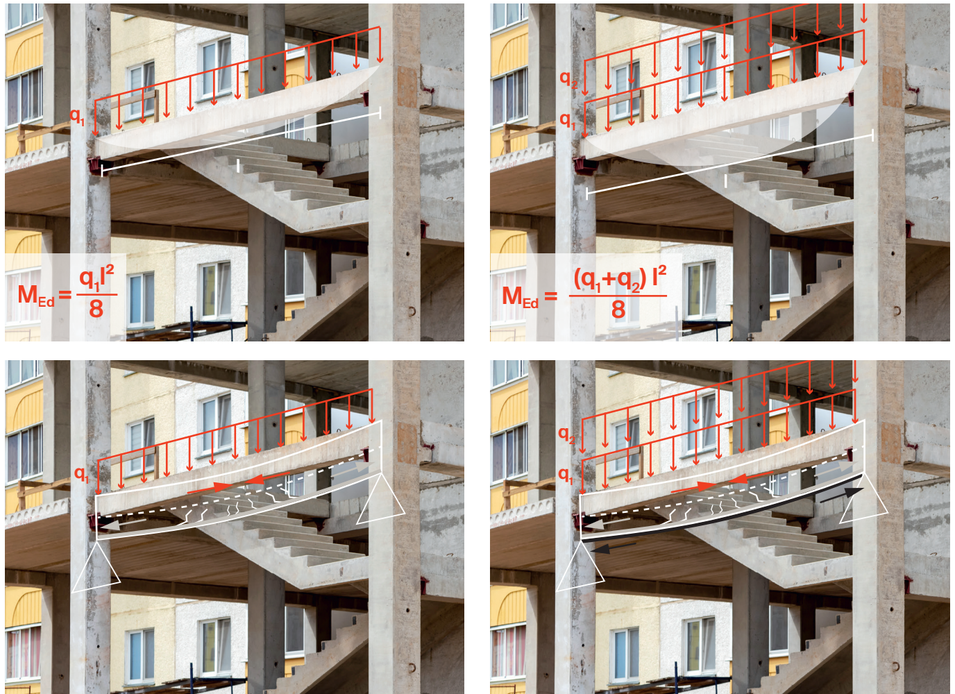
Abb. 4 – Links: unverstärkter Träger, rechts: biegeverstärkter Träger
