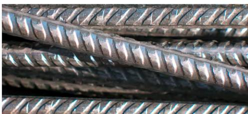
Gerippter Betonstabstahl B500 am Bau.
