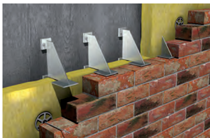
Dämmstoffe in zweischaligen Außenwänden
