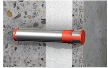
Detail: Sanierung von Wetterschalen
